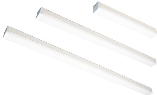
Hurdal ist eine hocheffiziente Anbauleuchte für eine Vielzahl von Anwendungen. Sie lässt sich einfach direkt an der Decke oder an der Wand installieren und verfügt über einen Kabeleintritt an beiden Enden sowie zwei in der Mitte. Die Leuchte ist IP44 mit Stahlfuss und Aluminium-Endkappen. Hurdal ist in drei Längen erhältlich. Kippschalter ermöglichen es, die Beleuchtungsstärke einzustellen.
