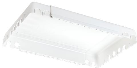
Multibox TEK ist ein ausziehbares Downlight-Gehäuse mit geringer Einbautiefe. Durch die geringe Einbautiefe von nur 48 mm kann auf Löcher in der Feuchtigkeitssperre verzichtet werden, indem man die Box in der Konterlattung tiefer setzt. Die Multibox TEK ist ausziehbar und einfach zwischen den Latten einzupassen. Hergestellt aus recycelbarem hitzebeständigem, halogenfreiem und flammhemmendem (V0) Material. L: 330-600 mm B: 250 mm H: 48 mm
