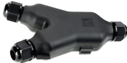
Die Gelbox I & Y sorgt für eine wasserdichte Kabelverbindung. Die Gelbox kann mehrmals geöffnet und geschlossen werden, um Messungen durchzuführen, neu zu verkabeln oder um die Box wiederzuverwenden. Die Gelbox enthält eine Anschlussbox mit Gel, inklusive Steckklemme für Kabel 1,5 mm<sup>2</sup>-2,5 mm<sup>2</sup> und Kabeleinführungen. Wählen Sie zwischen Verbindungsmuffe (I) oder Abzweigmuffe (Y).
