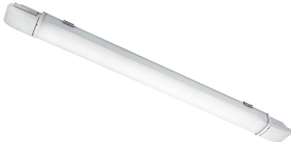
Luminaire IP66 pour montage au plafond. Réalisé en polycarbonate stabilisé aux UV. Homologué pour voies d'accès communes et protection antivandale IK10. Design élancé, mécanisme de fermeture unique à une main aux deux extrémités, pré-câblage traversant et possibilité de mise en boucle, installation très facile et rapide assurée, sans outils. Compatible chambres froides jusqu'à -25°C.
