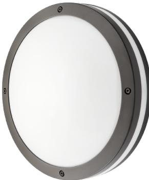
Hublot élégant rond avec lumière directe et indirecte, à montage mural ou au plafond, à l'extérieur et à l'intérieur. Réalisé en fonte d'aluminium, poudre polyester. diffuseur plat réalisé en polycarbonate opale stabilisé aux UV. Plusieurs versions de sources lumineuses et à détecteur. 2 passe-câbles, possibilité de câblage arrière ou latéral et connecteur rapide repiquable. Design: Hallvard Jakobsen
