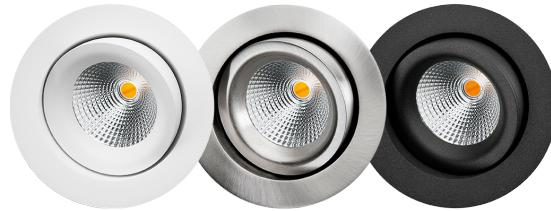
Luminaire pour l'intérieur, inclinaison 30 degrés, gyroscopique sur 360 degrés. Montage directement dans l'isolant déroulé. Module LED intégré avec DimToWarm 2000-2800K, dimmable par coupure de phase. Réalisé en fonte d'aluminium poudre polyester ou acier brossé, diffuseur verre. Encastrement faible hauteur diamètre de perçage Ø83mm. Montage sans outils avec connecteur rapide repiquable.
