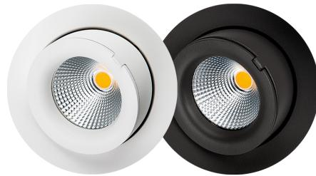
Luminaire pour l'intérieur et l'extérieur (sauf acier brossé), convient particulièrement aux murs mansardés et éclairages à effet grâce à l'inclinaison unique à 40 degrés. Module LED intégré avec alimentation dimmable. Réalisé en fonte d'aluminium poudre polyester ou acier brossé, diffuseur verre. Faisceau 42 degrés. Encastrement faible hauteur avec diamètre de perçage Ø83.
