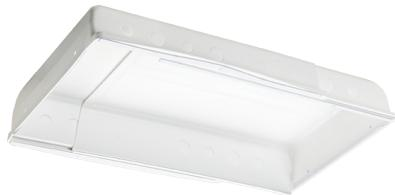
Boîtier d'encastrement plafond, longueur réglable de 33 à 60 cm, pour installation sous le pare-vapeur, par simple vissage sur chevrons. Empreintes défonçables de 16 et 20 mm, sur chaque longueur, pour passage et fixation des gaines-câbles. Fabriqué en matériau recyclé, résistant à la chaleur, sans halogène et ignifuge (V0) (UL94) – 850°C (IEC-695-2-1). L: 330-600 mm B: 280 mm H: 65 mm
