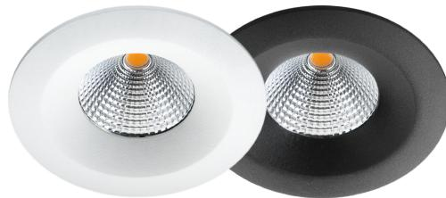
Luminaire IP65 pour applications intérieures et extérieures, compatible pour l'installation dans le Volume 1 des salles de bains. Etanchéité à l'air garantie grâce à une membrane située entre le plafond et la colerette du luminaire, avec installation possible directement dans l'isolant (ISOSAFE / BBC RT 2012). Alimentation électronique déportée de 1.20 mètre (câble fourni). Montage sans outils grâce au connecteur rapide repiquable.
