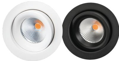
Le meilleur encastré LED du marché pour une utilisation en intérieur et extérieur. Luminaire avec un faisceau de 42°, offrant une inclinaison de 30° sur un axe, pour une utilisation en intérieur. Fonte d'aluminium et acier laqué avec diffuseur en verre. Dimmable par coupure de phase en aval. Système à faible hauteur d'encastrement, convient bien à la rénovation avec ses diamètres de perçages de Ø68 mm à Ø83 mm.
