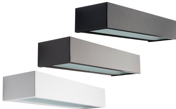
Attraktive, eckige Wandleuchte zur waagerechten/senkrechten Montage außen/innen. Versionen als Down-/Uplight oder mit nur einem Lichtaustritt, IP65, integrierte LED, Montagerückplatte mit 2 Kabeleinführungen, Möglichkeit für sichtbare oder verborgene Kabelführung, sowie Steckklemmen mit Möglichkeit zur Durchverdrahtung.
