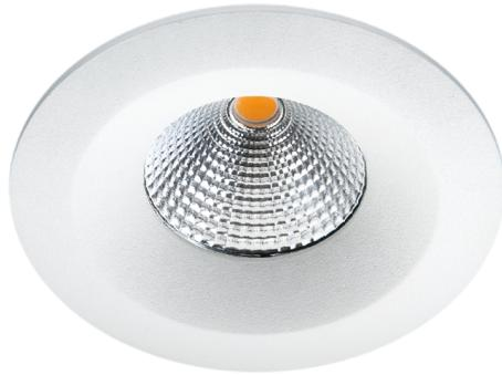
Attraktives Downlight für Innen- und Außenbereiche mit zertifizierter Airtight-Funktion: Eine Dichtungsmembran zwischen Decke und Downlight sorgt für Luftpichtigkeit von unten. Die Montage kann direkt an der Dämmung bzw. Dampfsperre erfolgen. Gehäuse aus pulverbeschichtetem Druckgussaluminium oder – für Innenbereiche – aus gebürstetem Stahl, mit Glasabdeckung der Lichtquelle. Schutzart IP65.
