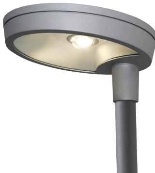
Design: Christian Hvidt. Luminaire pour montage sur mât, IP65. Corps de luminaire en fonte d'aluminium, poudre polyester gris ou noir texturé. Réflecteur en aluminium, poudre polyester blanc. Optique parfaite pour une diffusion directe de la lumière par le verre frontal trempé. Complet avec driver LED pour sources lumineuses LED montées sur rail à composants, pré-câblé avec 6m de câble de raccordement. Tête d'éclairage prête au montage sur mât 60mm. Protection électrique classe II. IK09
