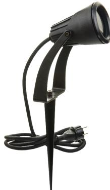
Le Flora est un spot sur piquet ou mural pour l'extérieur, faisceau 36 degrés, source lumineuse remplaçable GU10 (comprise), IP65, IK08, classe II, livré monté avec câble de 2m et fiche, dimmable par coupure de phase. La tête, qui peut pivoter à 360°, est équipée de crans "anti-bascule". Le spot Flora intègre 1 joint autour de la source pour son centrage et 1 joint sous la collerette de serrage pour son étanchéité.
