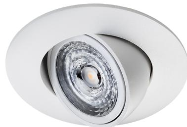
Downlight pour l'intérieur. Inclinaison unique 45 degrés, avec perte minimale de lumière du fait de l'inclinaison sur le dernier tiers de la coupe du luminaire. Lampe LED GU10 Dimmable, remplaçable (comprise). Réalisé en fonte d'aluminium poudre polyester ou acier brossé. Diamètre de perçage Ø83mm.
