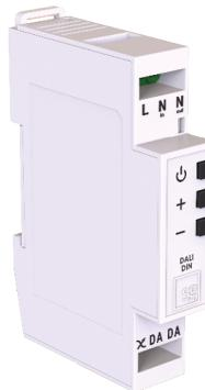
Permet d'utiliser toutes les sources lumineuses à variation à Coupure de phase dans un environnement DALI. Convertit un signal DALI en variation à Coupure de phase. Il est possible de regrouper plusieurs luminaires à variation à Coupure de phase sur une même adresse DALI afin de simplifier l'installation en limitant le nombre d'adresses. Permet de gagner du temps et de l'argent par rapport à une installation 100 % DALI. Montage sur rail DIN.
