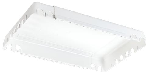
Boîtier d'encastrement plafond/mur, longueur réglable de 33 à 60 cm, de très faible hauteur (4,8 cm), pour installation sous le pare-vapeur, par simple vissage sur chevrons. Ouvertures de 16 et 20 mm, sur chaque côté, pour passage et fixation des gaines-câbles. Fabriqué en matériau recyclé résistant à la chaleur, sans halogène et ignifuge (V0) (UL94) – 850°C (IEC-695-2-1). L: 330-600 mm B: 250 mm H: 48 mm
