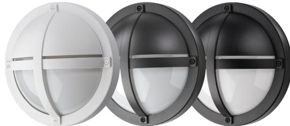
Design: Hallvard Jakobsen. Luminaire mural rond avec casquette et croisillon à montage extérieur et intérieur. Réalisé en fonte d'aluminium, poudre polyester. diffuseur en polycarbonate opale stabilisé aux UV. 2 entrées/sorties de câbles, possibilité de câblage visible ou caché et connecteur rapide repiquable. IP65 et protection antivandale IK10.
