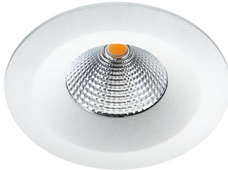
Luminaire plat pour l'intérieur et l'extérieur. Etanchéité à l'air par le bas certifiée par l'intermédiaire d'un joint entre le plafond et l'anneau downlight et montage directement dans l'isolant déroulé ou soufflé. Module LED efficace dimmable par coupure de phase. Réalisé en fonte d'aluminium coulé sous pression, laqué poudre ou acier brossé (uniquement à l'intérieur), protection verre.
