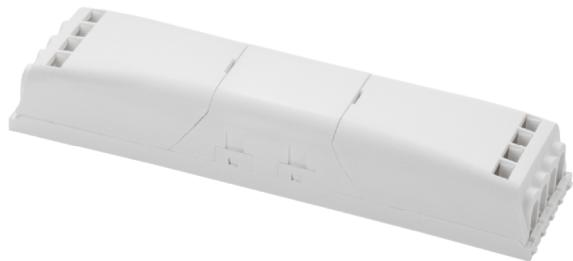
Scatola di derivazione per sostituire il trasformatore quando si sostituiscono i faretti a 12V con quelli a LED a 230V. È dotata di un morsetto di collegamento a 3 poli in entrata e di un morsetto di collegamento a 4 poli in uscita, per cui può essere utilizzata per un massimo di 4 faretti.
