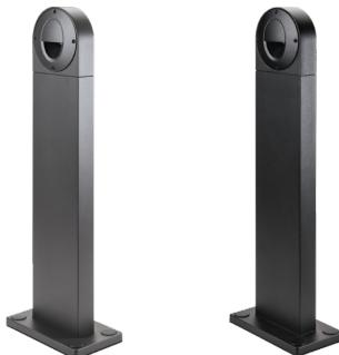
Callisto Bollard è un apparecchio a LED sottile con distribuzione asimmetrica della luce, adatto per spazi pubblici e giardini. Altezza totale: 60 cm. Chip LED integrato ed efficiente. Dimmerabile con dimmer a taglio di fase. Può essere avvitato e ancorato a piastrelle o cemento (accessorio). 230 V diretto con morsetti rapidi passanti. Parte anteriore fissata con vite torx. Realizzato in alluminio pressofuso verniciato a polvere. Schermo in vetro.
