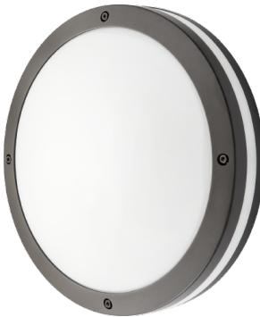
Elegante oblò rotondo a luce diretta e indiretta, da montare a parete o a soffitto, in ambienti interni o esterni. Realizzato in fusione di alluminio con verniciatura a polvere di poliestere. Diffusore piatto in policarbonato opalino stabilizzato ai raggi UV. Diverse versioni di sorgenti luminose e sensori. 2 pressacavi, possibilità di cablaggio posteriore o laterale e connettore a sgancio rapido. Design: Hallvard Jakobsen
