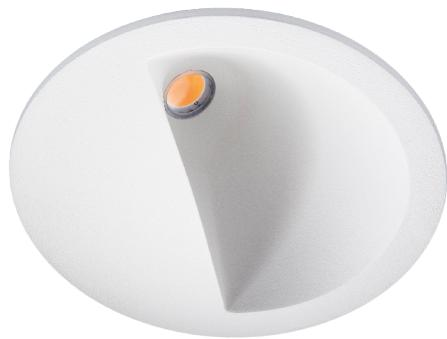
Attraente downlight per interni, particolarmente adatto per specchi e illuminazione d'effetto. Curva luminosa asimmetrica, chip LED ben integrato e driver dimmerabile associato. Realizzato in alluminio pressofuso verniciato a polvere. Angolo di diffusione di 100 gradi. Montaggio a superficie bassa con foro Ø83.
