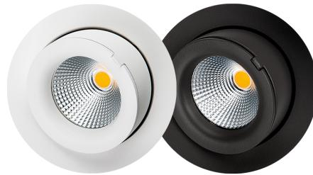
Attraente downlight per interni, particolarmente adatto alle pareti inclinate e all'illuminazione d'effetto grazie all'esclusiva punta a 40 gradi. Chip LED ben integrato e relativo driver dimmerabile. Realizzato in alluminio pressofuso verniciato a polvere o acciaio spazzolato, diffusore in vetro. Angolo di apertura del fascio luminoso di 42 gradi. Faretto da incasso basso con foro di Ø83 mm
