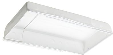
Scatola da incasso a soffitto, lunghezza regolabile da 33 a 60 cm, per l'installazione sotto la barriera al vapore, semplicemente avvitata ai travetti. Foro da 16 e 20 mm su ogni lunghezza per il passaggio e il fissaggio delle canaline. Realizzato in materiale riciclato, resistente al calore, privo di alogeni e ignifugo (V0) (UL94) - 850°C (IEC-695-2-1). L: 330-600 mm B: 280 mm H: 65 mm
