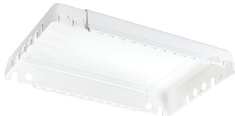
Scatola da incasso a soffitto/parete, lunghezza regolabile da 33 a 60 cm, profilo molto basso (4,8 cm), per l'installazione sotto la barriera al vapore, semplicemente avvitata ai travetti. Aperture di 16 e 20 mm su ogni lato per il passaggio e il fissaggio delle canaline. Realizzato in materiale riciclato resistente al calore, privo di alogeni e ignifugo (V0) (UL94) - 850°C (IEC-695-2-1). L: 330-600 mm B: 250 mm H: 48 mm
