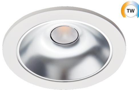
Faretto da incasso a LED. Realizzato in policarbonato ignifugo. Fornito con LED 2700-6500K Tunable White LEDDim o Dali Type 8. Completo di alimentatore e connessione rapida tra alimentatore e downlight per un'installazione facile e veloce. Può essere installato in pannelli del soffitto di spessore 1-50 mm. Apparecchio completo di anello in alluminio fuso. Riflettore opaco
