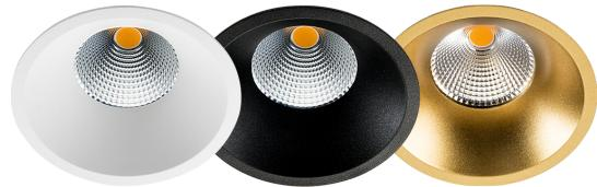
Apparecchio da incasso per interni ed esterni, particolarmente adatto all'illuminazione generale grazie al suo bassissimo abbagliamento. Modulo LED integrato con alimentazione dimmerabile. Realizzato in fusione di alluminio, polvere di poliestere e diffusore in vetro. Fascio di luce di 42°. Altezza di incasso ridotta con diametro del foro di Ø83 mm.
