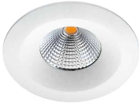
Faretto da incasso per interni ed esterni con angolo di emissione di 42°. La tecnologia avanzata del riflettore e la sorgente luminosa a incasso garantiscono un'elevata resa luminosa. I nostri prodotti IsoSafe possono essere installati direttamente nell'isolamento. Installazione senza attrezzi e possibilità di ricablaggio. Altezza di installazione molto ridotta, 35 mm.
