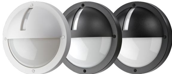
Elegante oblò rotondo a parete con tappo e finestra per installazione interna ed esterna. Realizzato in fusione di alluminio con verniciatura a polvere poliestere. Diffusore in policarbonato opalino stabilizzato ai raggi UV. 2 pressacavi, possibilità di cablaggio posteriore o laterale e connettore a sgancio rapido. Design: Hallvard Jakobsen.
