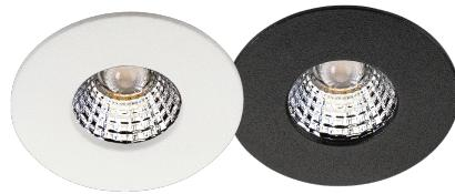
Downlight compatto per cornici, armadi o scaffali, per una bella luce soffusa. Nano viene fornito con un riflettore di 15 o 36 gradi. Nano sono forniti senza alimentatore. Il diametro di Nano non è più grande di una moneta da 2 euro e il suo driver da 4,2 W ha un diametro di 23 mm, che gli consente di inserirsi facilmente in un foro del soffitto.
