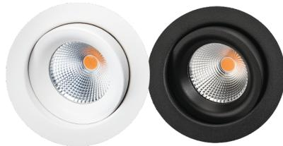
Il miglior apparecchio LED da incasso sul mercato per uso interno ed esterno. Apparecchio con fascio di luce di 42°, inclinabile di 30° su un asse, per uso interno. In fusione di alluminio e acciaio laccato con diffusore in vetro. Dimmerabile con taglio di fase a valle. Sistema a basso profilo, adatto a ristrutturazioni con fori di diametro compreso tra Ø68 mm e Ø83 mm.
