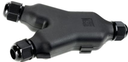
Gelbox assicura una giunzione impermeabile dei cavi. La scatola di giunzione può essere aperta e chiusa più volte, ad esempio per misurare il controllo, sostituire il cavo o riutilizzarlo. Fornita completa di scatola di giunzione con gel, connettore per cavo da 1,5 mm<sup>2</sup>-2,5 mm<sup>2</sup> e nippali di tenuta. Scegliere tra giunzione diritta (I) o giunzione sdoppiata (Y).
