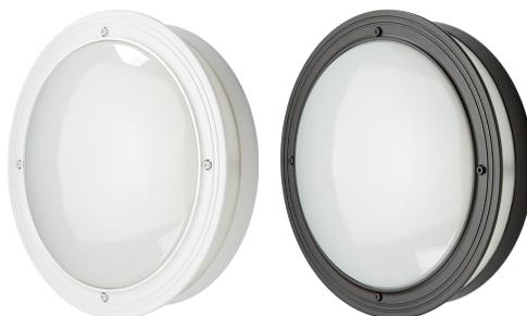
Design: Svein Knudsen / Andrew Smith. Hublot rond montage mural ou en plafonnier, à l'extérieur et à l'intérieur. Réalisé en fonte d'aluminium, poudre polyester. diffuseur plat réalisé en polycarbonate opale stabilisé aux UV. Efficace et puissant avec plusieurs variantes de sources lumineuses et possibilité de détecteur. 2 passe-câbles, possibilité de câblage arrière ou latéral et connecteur rapide repiquable. IP65 et Diffuseur antivandale IK10.
