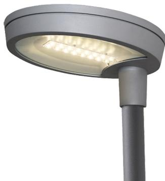
Minimalistisk gatulusarmatur. CircLED Multi har en linsoptik med längsgående ljusfördelning, optimerad för lokalgator, gång-och cykelväg och parkeringar. Färdig för installation med förmonterad 6 meter kabel, 2x1 mm<sup>2</sup>. Montering på Ø60mm stolptopp eller sidomonterad på armfäste med diameter på Ø48mm. Armaturhus av formgjuten aluminium och härdat glas. Design: Christian Hvidt
